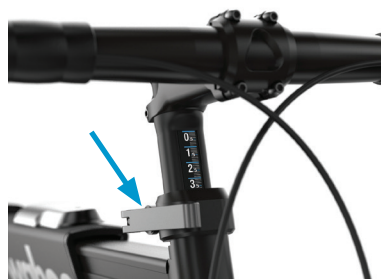
Réglage de la hauteur du cadre
