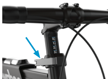
Regolazione altezza stack
